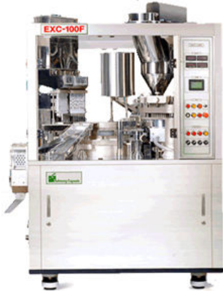
그림 10. 캡셀 공정을 위한 자동화 설비
